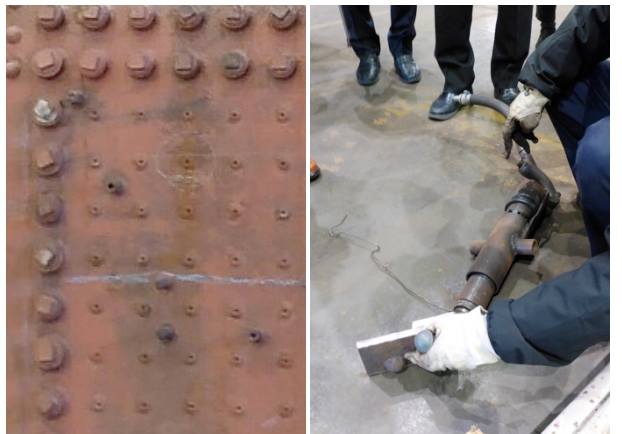
写真5 C571の外火室外面 写真6 リベット打ちの説明 写真5では外面にステーの取り付け金具や端面が見える(撮影：寺島俊之)
